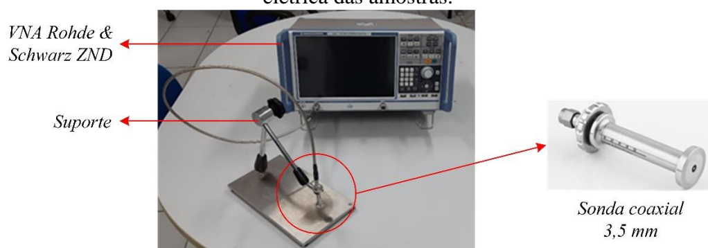
Figura 58 – Sonda coaxial e VNA Rohde & Schwarz ZND utilizados para caracterização elétrica das amostras.
