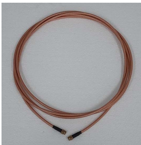
Figura 62 – Cabo coaxial RG 142 utilizado para medição de refletividade através do setup construído.
