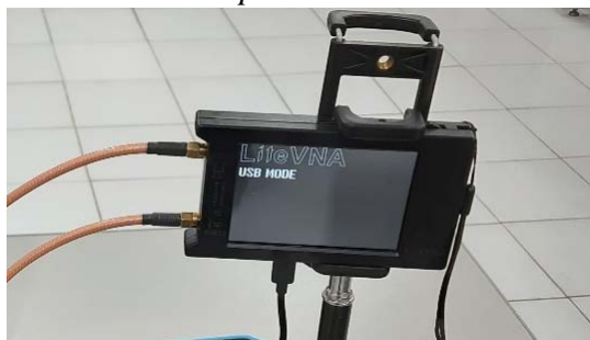
Figura 61 – Lite VNA 50 KHz – 6,3 GHz utilizado para medição de refletividade através do setup construído.
