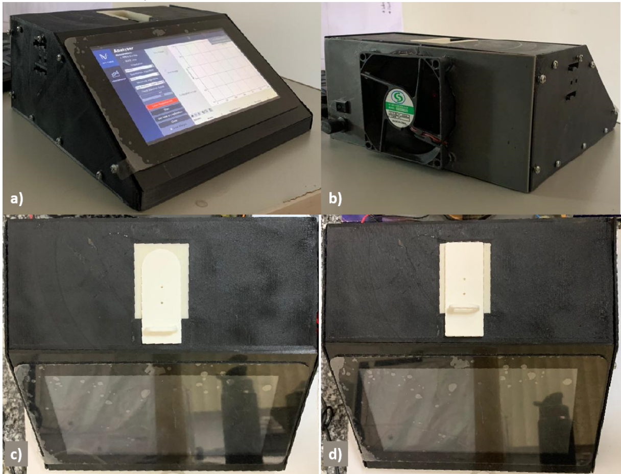
Figura 22 – Fotografias do protótipo do Sensor SBC-SPR. a) vista frontal, b) vista traseira e vista superior com elementos de tampa superior para os biochips c) DOCE-chip e d) PPBIO.
