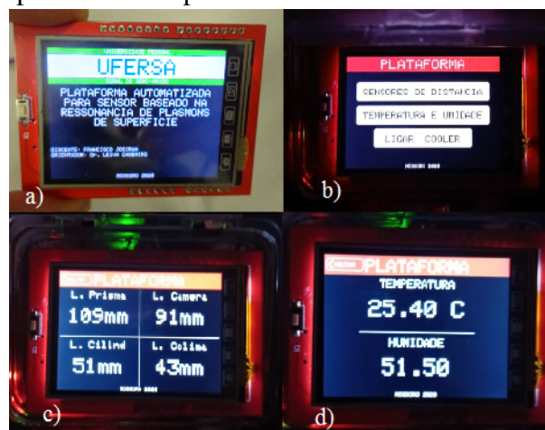
Figura 43 – Interface Touch Screen: a) Apresenta a tela de inicialização principal; a Figura b) Apresenta ao usuário os submenus: Sensores de distância, Temperatura, umidade e liga/desliga cooler manualmente; a Figura c) Apresenta ao usuário a distância em mm da Lente Colimadora e Cilíndrica, Prisma e a Câmera em relação a sua base e a Figura d) Apresenta a temperatura ambiente no interior do case.
