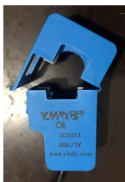
Figura 5: Imagem física do TC utilizado no projeto (Modelo: SCT013-030).
