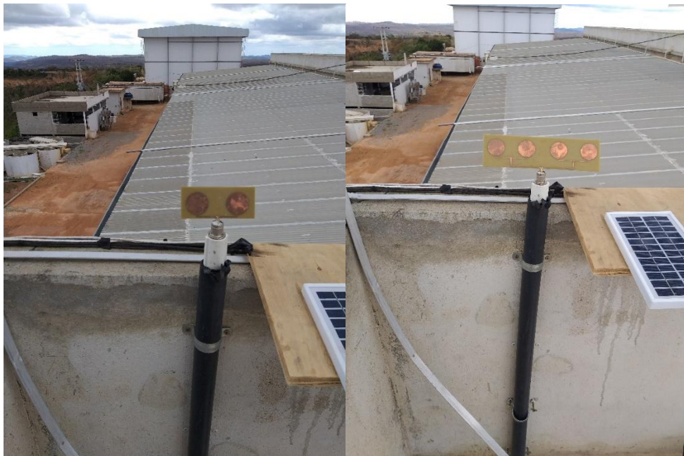
Figura 74-(a) Antena receptora 1x2. (b) Antena Receptora 1x4
