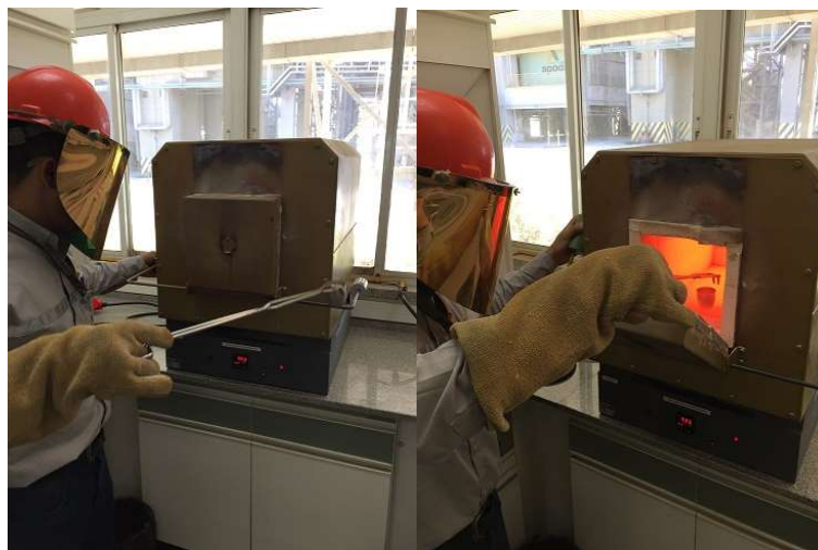
Figura 41: Início do processo de fundição Fonte: Autoria própria
