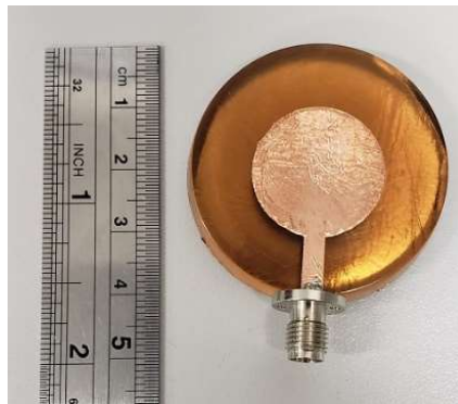
Figura 59: Detalhe construtivo da antena 1 Fonte: Autoria própria
