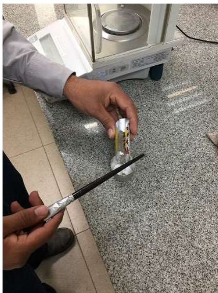
Figura 40: Introdução do material no cadinho para fundição Fonte: Autoria própria
