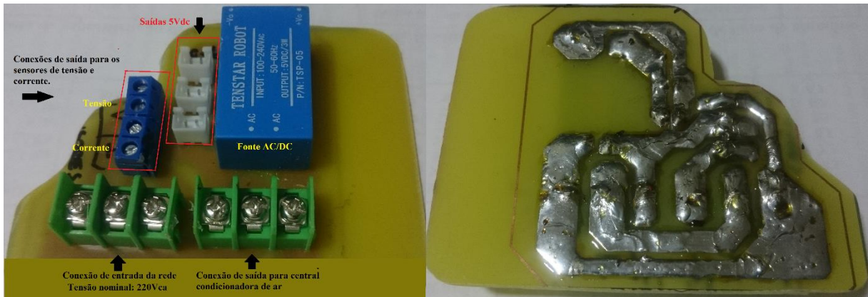
Figura 31 – Placa de força. Fonte: Autoria própria.
