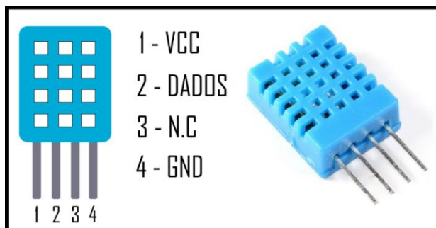
Figura 11 – Sensor DHT-11 e indicação da correta conexão aos pinos do sensor. Fonte: Autoria própria.
