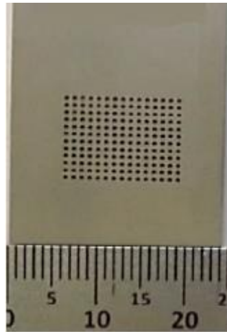
Figura 30: Arranjo periódico de PBG no substrato da antena de microfita
