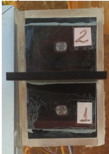
Figura 35 – Sensor de posicionamento utilizado no painel FV móvel
