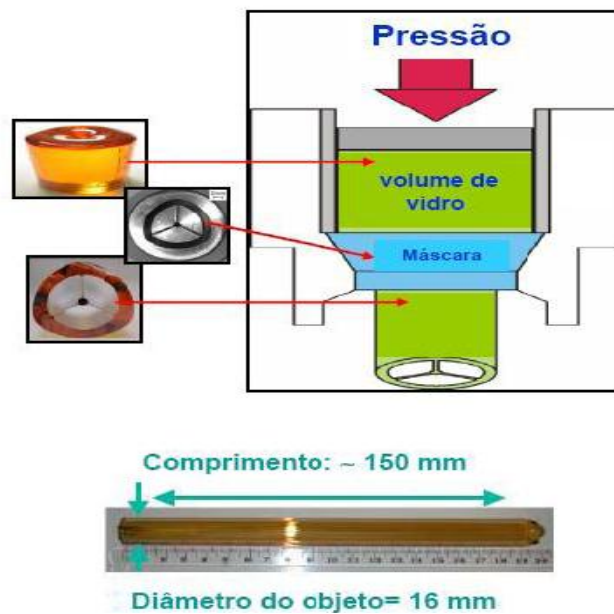
Figura 2.15: Esquema da fabricação de pré-formas por extrusão e tamanho típico da pré-forma fabricada
