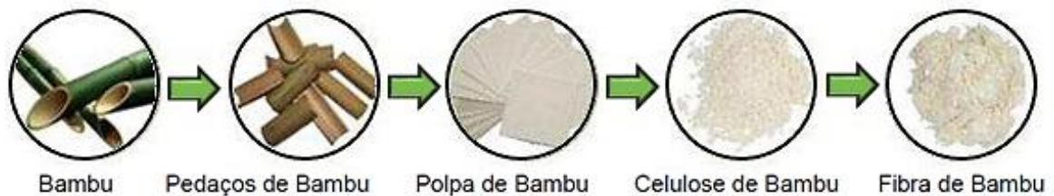
Figura 33 - Sequência da fabricação da fibra de Bambu.
