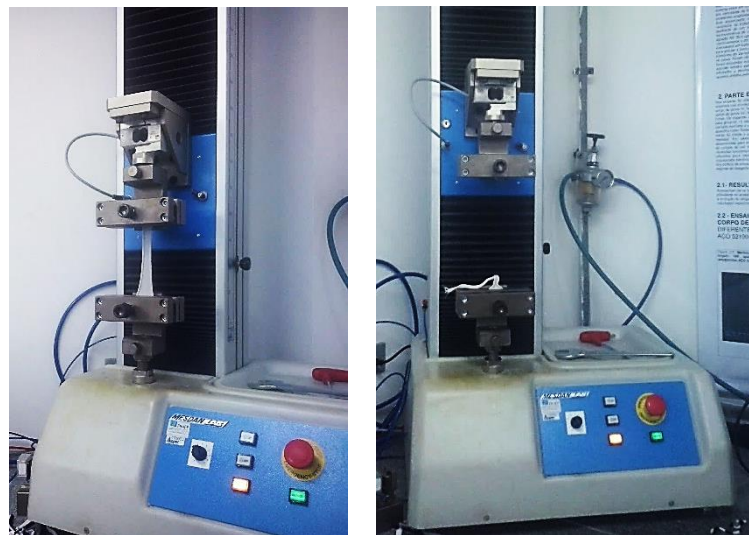
Figura 67 - Ensaio de resistência a tração (a) Antes da ruptura; (b) Após da ruptura.
