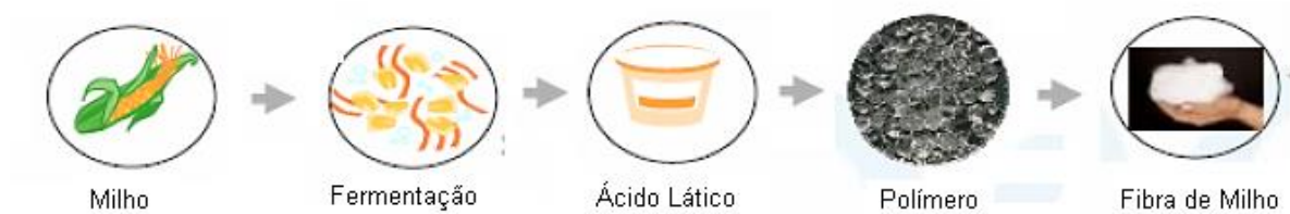
Figura 31 - Processo de obtenção da fibra de milho.
