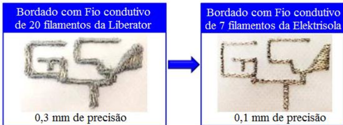
Figura 58 - Comparação entre as técnicas de fabricação de antenas têxteis utilizando fio condutor bordado.
