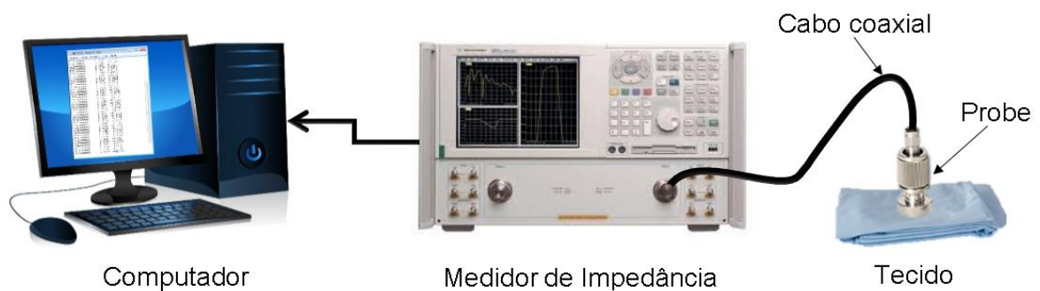
Figura 62 - Método da sonda coaxial utilizado.
