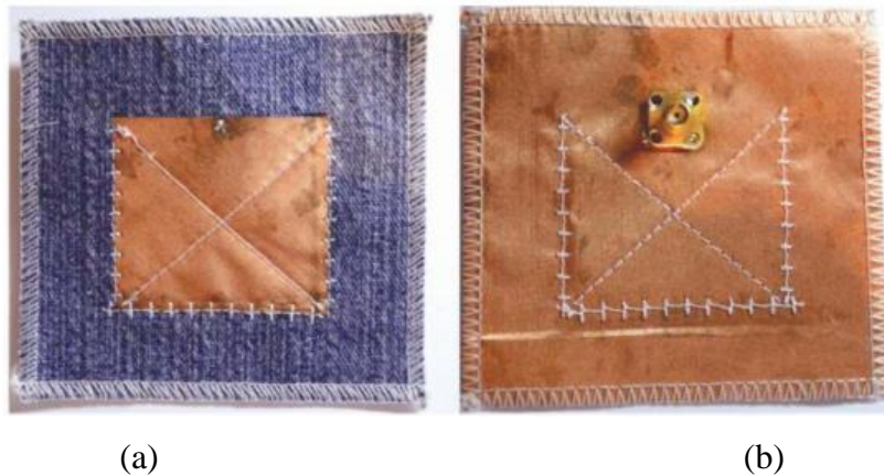
Figura 54 - Antena têxtil com patch PCPTF e substrato Jeans: vista frontal (a) e posterior (b).
