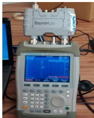
Figura 47 – Analisador de espectro Rohde & Schwarz FSH6.
