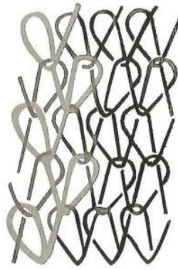
Figura 22 – Estrutura do tecido de malha por urdume.
