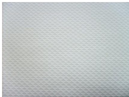
Figura 29 – Diagrama do lado avesso de um tecido de malha com estrutura piquet.
