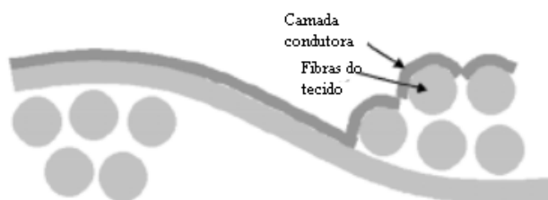
Figura 32 – Camada condutora aplicada no tecido confeccionado.
