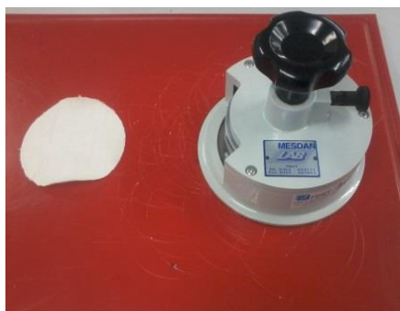
Figura 38 – Cortador circular MESDAN 1 dm 2 .
