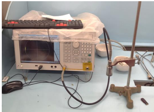
Figura 43 – Medidor de impedância Agilent 85070E.
