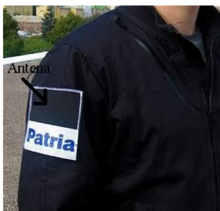
Figura 33 – Antena têxtil aplicada no ombro do vestuário.
