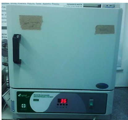
Figura 42 – Estufa de bancada utilizada para simular a secagem ambiente.
