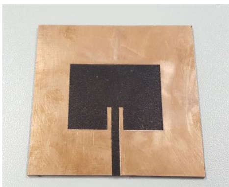
Figura 36: Antena FR4 antes da segunda corrosão.
