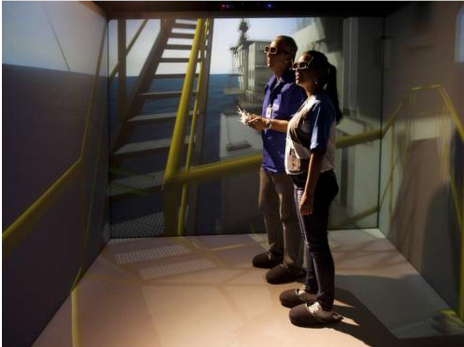
Figura 3: Simulador utilizado para navegação em plataformas de petróleo. Grupo de Simulação e Controle em Automação - GSCAR da UFRJ. Fonte: (GSCAR, 2010).
