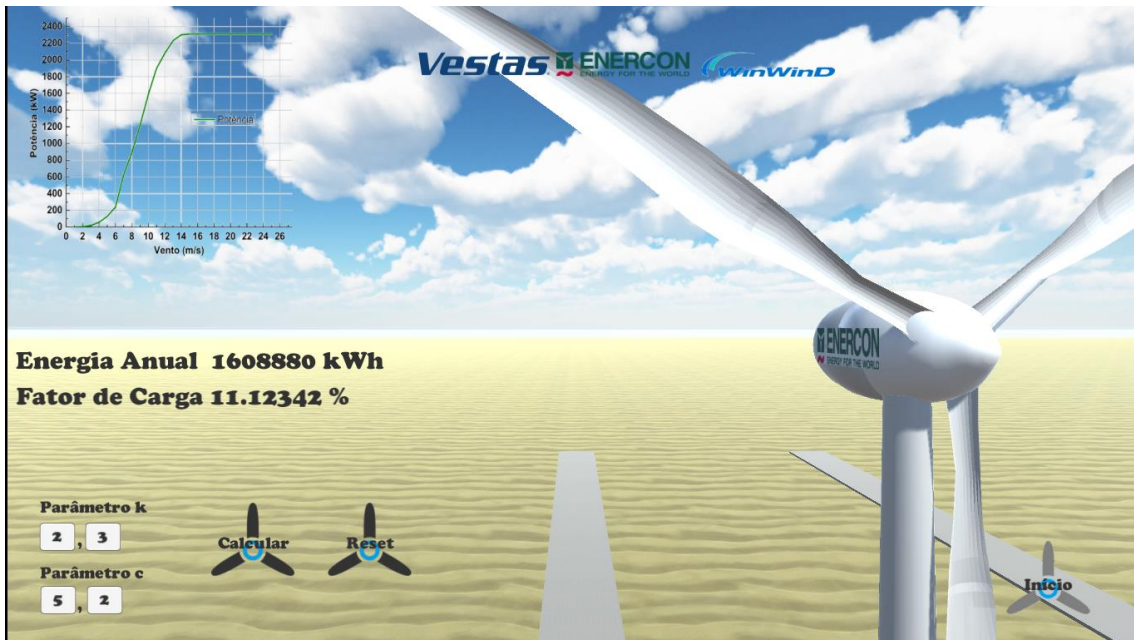
Figura 6.15 - Simulação de Produção de Energia em Mossoró-RN com aerogerador modelo Enercon.
