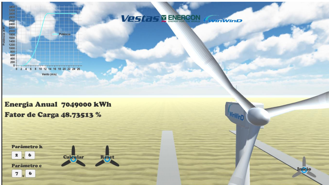
Figura 6.13 - Simulação de Produção de Energia em Tibau-RN com aerogerador modelo WinWind.
