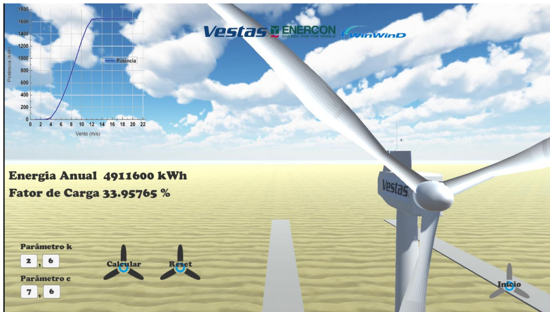
Figura 6.11 - Simulação de Produção de Energia em Tibau-RN com aerogerador modelo Vestas.
