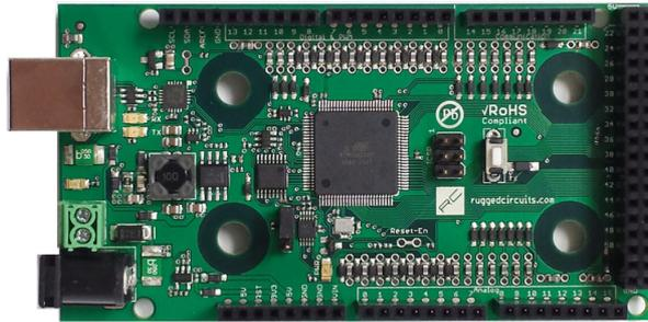
Figura 6 - Rugged MEGA, versão aprimorada do Arduino Mega 2560
