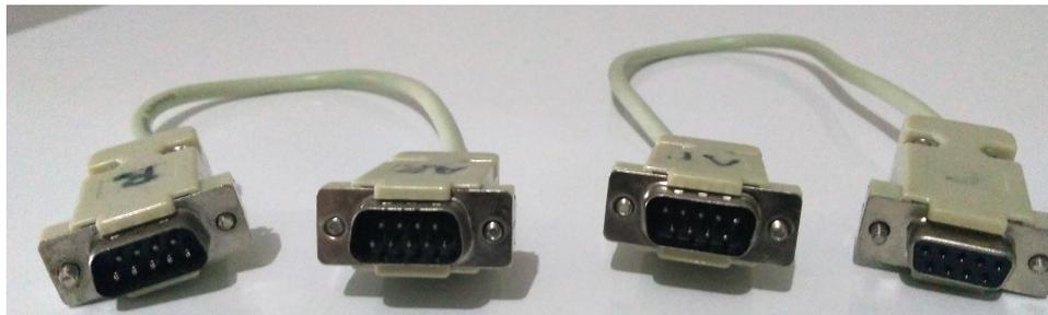
Figura 25 - Cabos para comunicação com rádio e conversor 232/485
