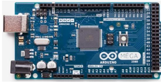
Figura 4 - Arduino® Mega 2560
